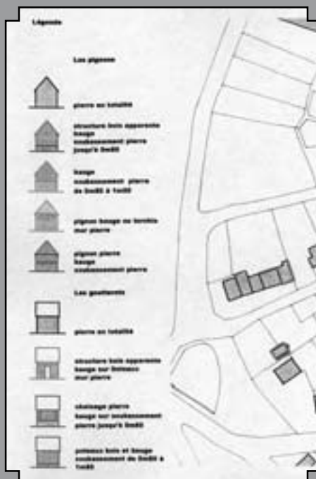
Fig. 2 : Typologie des différentes mises en œuvre de la bauge à Tilly (Luc Joudinaud, architecte du patrimoine).
