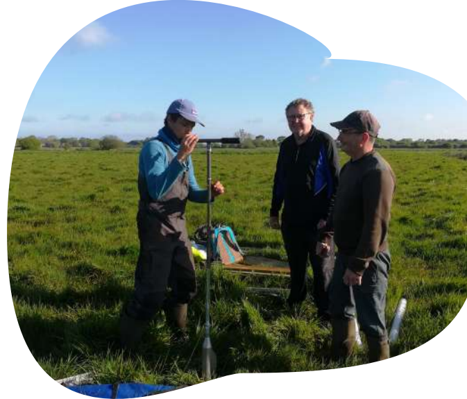
Pose de piezomètres, Saint-Germain-sur-Sèves
