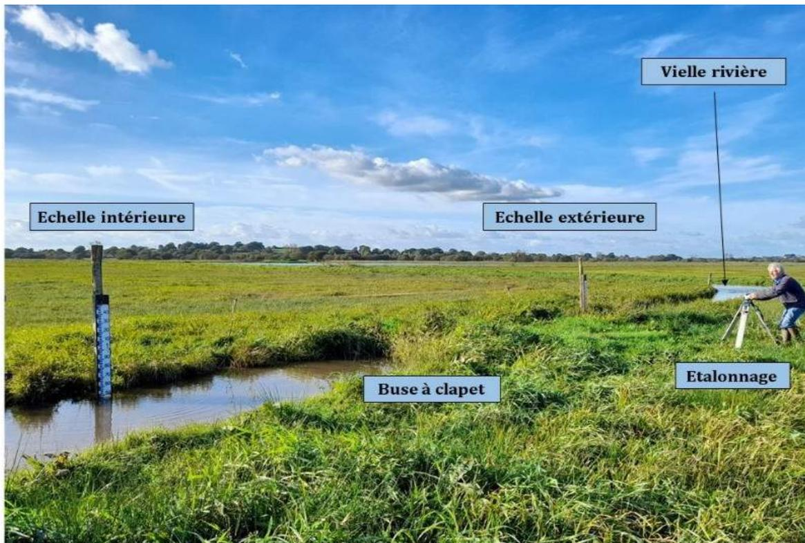
*Etalonnage d'une nouvelle échelle limnimétrique – RNR marais de la Taute*
